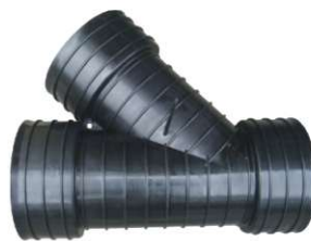
سه راه ۲۰۰ یا ۲۵۰ - ۴۵ درجه قالبی سه سر کوپلر با رینگ های تقویتی
